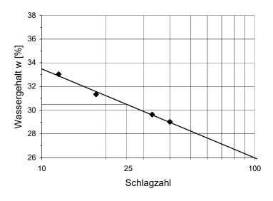
Wassergehalt (w) 22,2% Anteil Überkorn (ü) 0,0% Wassergehalt Überk. (w<sub>ii</sub>) 0,0% Korr. Wassergehalt 22,2% Fließgrenze (w<sub>I</sub>) 30,5% Ausrollgrenze (w<sub>p</sub>) 19,7% Plastizitätszahl (Ip) 10,8% 76,7% Konsistenzzahl (I<sub>c</sub>) **Bodengruppe** TL
